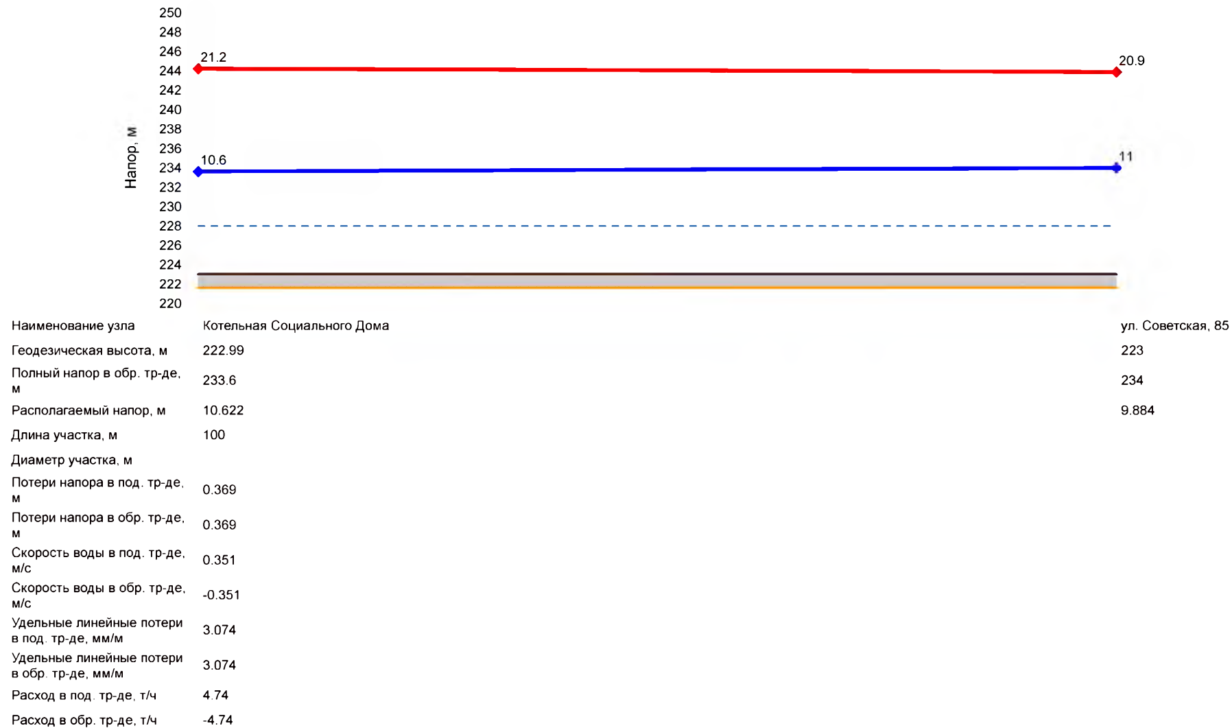
Рис. 16 – Пьезометрический график Котельной Социального дома
